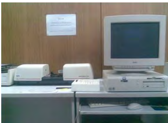
รูปที่ 3.3 เครื่องอัลตราไวโอเลตสเปกโตรโฟโตมิเตอร์ รุ่น specord s 100
