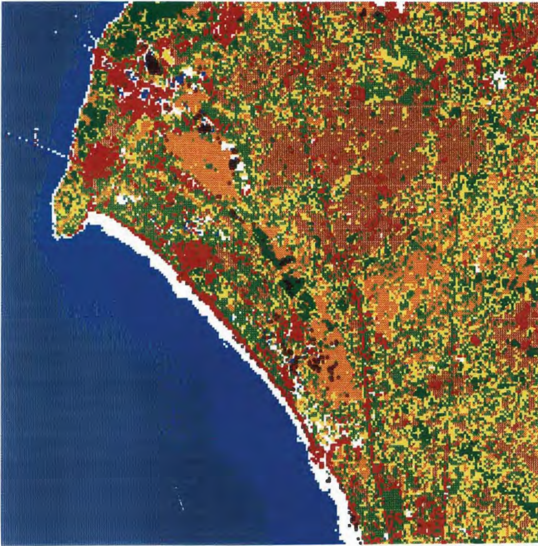
รูปที่ 3.14 การจำแนกการใช้ที่ดินบริเวณแหลมจบัง (SPOT, 28 ธันวาคม 2529)
