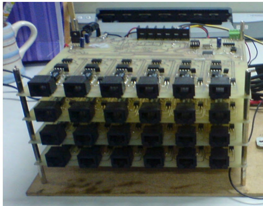
รูปที่ 4.11 เครื่องต้นแบบของเครื่องรวบรวมข้อมูล
