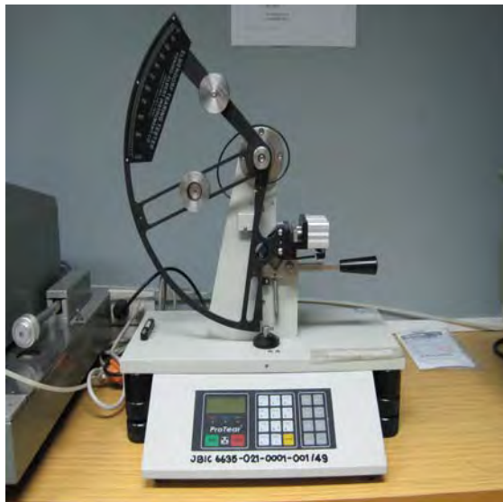
รูปที่ 3-5 เครื่องวัดความต้านทานแรงฉีก (tear tester)
