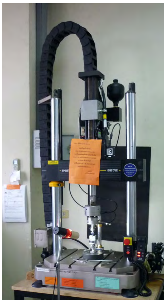
ภาพที่ 6 เครื่องทดสอบความทนแรงอัด ผลิตภัณฑ์ Instron 8872 (Instron Ltd., High Wycombe, UK)
