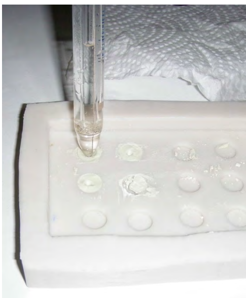
ภาพที่ 3 แสดงการวัดความเป็นกรดบนผิวซีเมนต์
