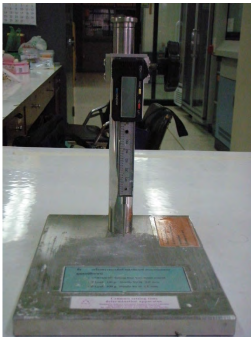
ภาพที่ 5 แสดงเครื่องวัดเวลาแข็งตัว และพื้นผิวซีเมนต์ที่มีรอยกดลักษณะต่าง ๆ
