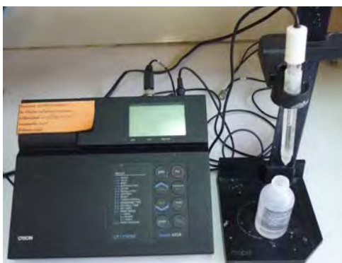
ภาพที่ 2 เครื่องวัดความเป็นกรดต่าง ผลิตภัณฑ์ Orion 370
