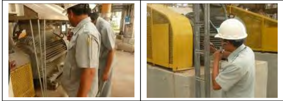
รูปที่ 6.7 การตรวจสอบความผิดปกติโดยการใช้เครื่องฟังเสียง
