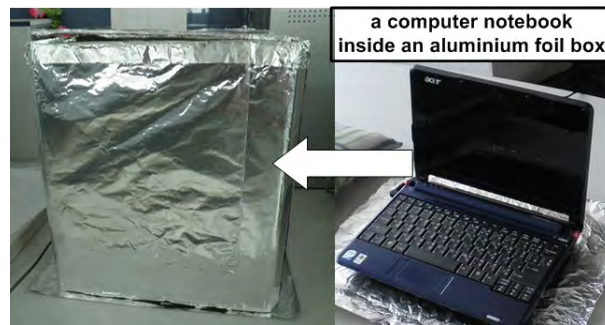
รูปที่ 3.13: การลดรัศมีการส่งต่อเพื่อให้เหมาะสมกับการทดลองระยะสั้น
