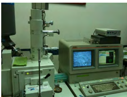
รูปที่ 3.16 กล้องจุลทรรศน์อิเล็กตรอนแบบส่องกราด
