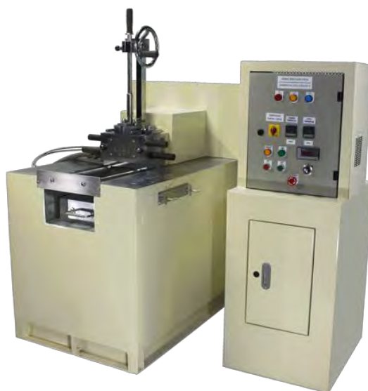
รูปที่ 3.5 เครื่องผสมแบบปิด
