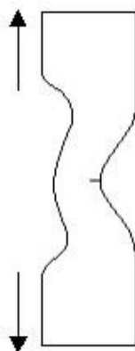
รูปที่ 3.12 ลักษณะชิ้นทดสอบความทนแรงฉีกขาดตามมาตรฐาน ISO 34 [21]
