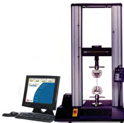
รูปที่ 3.10 เครื่องทดสอบเอนกประสงค์
