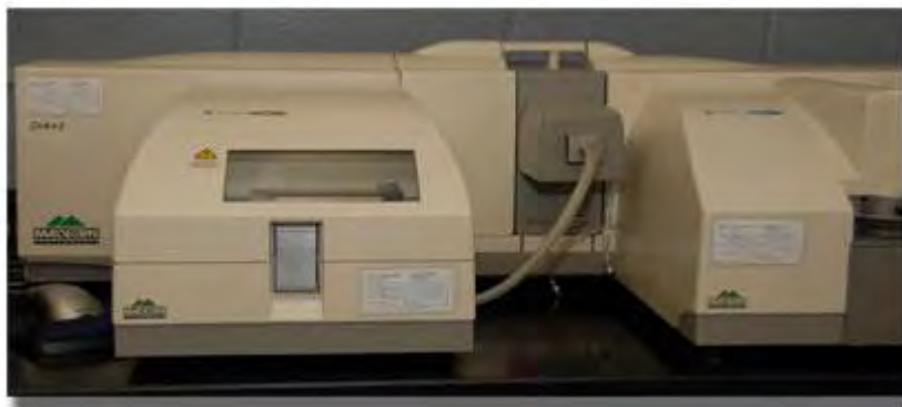
รูปที่ 3.4 เครื่องทดสอบหาขนาดอนุภาค laser light scattering
