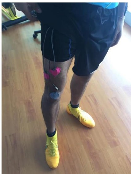
ภาพแสดงการติดขั้วไฟฟ้าแบบพื้นผิวในการวัดคลื่นไฟฟ้ากล้ามเนื้อที่กล้ามเนื้ออวาสตัส แลเทอราลิส
