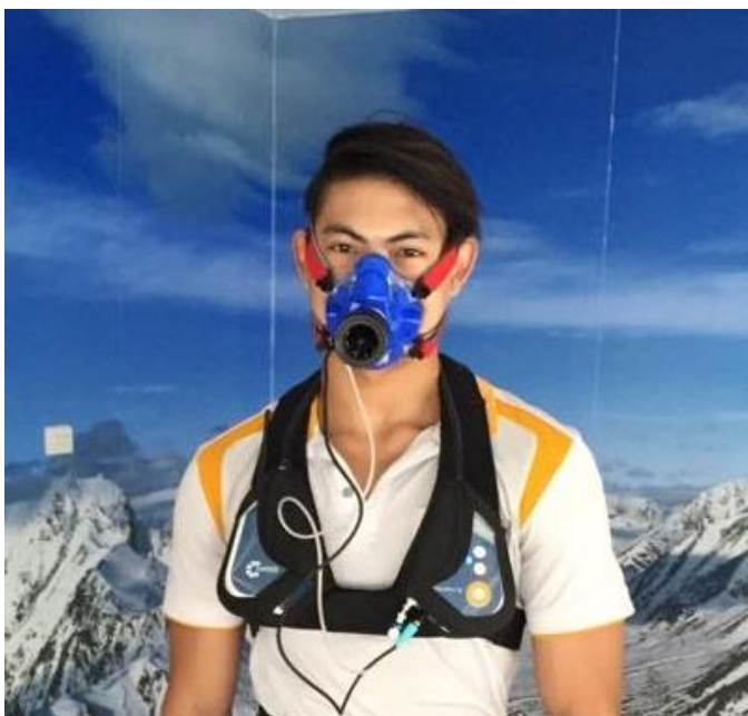
ภาพที่ 1 ภาพประกอบแสดงการติดตั้งเครื่องวิเคราะห์แก๊ส
