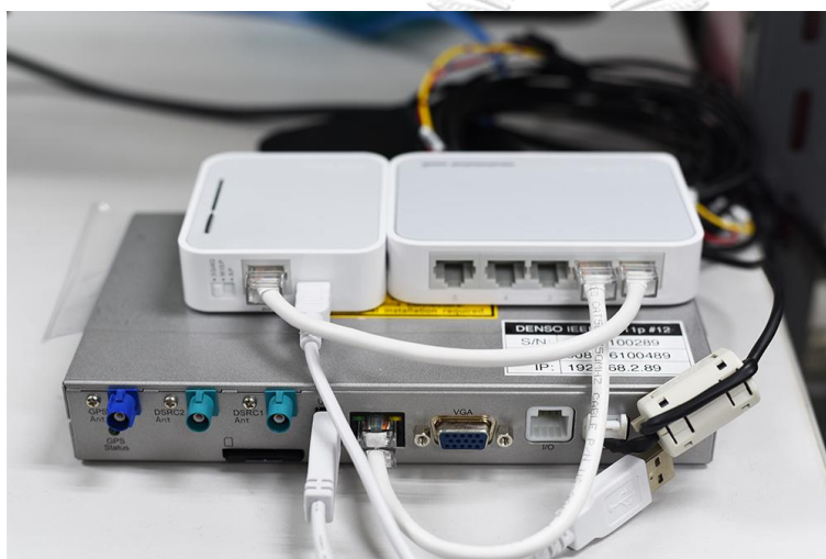
ภาพที่ 3.1 อุปกรณ์การสื่อสารไร้สายมาตรฐาน IEEE 802.11p DENSO WSU
