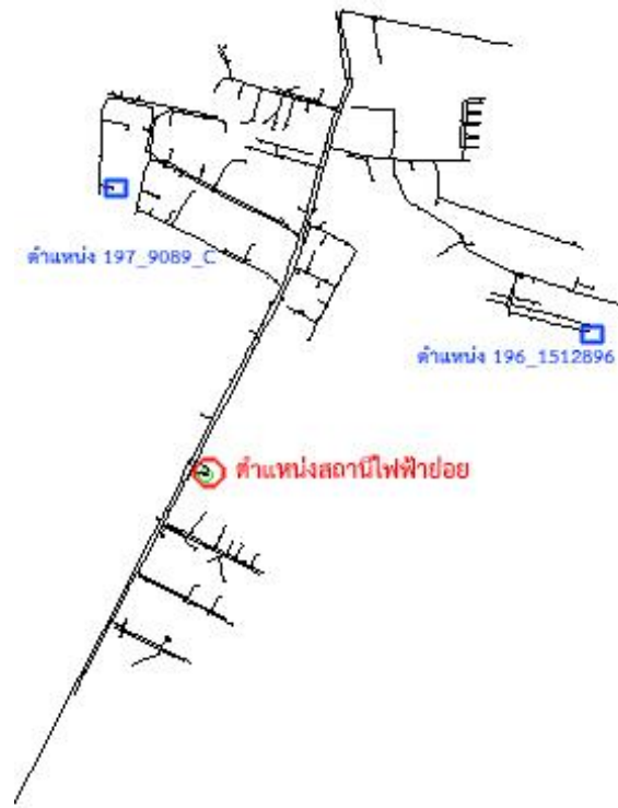
รูปที่ 4.10 แสดงตำแหน่งการเชื่อมต่อบรรบบผลิตไฟฟ้าพลังงานแสงอาทิตย์ของระบบจำหน่ายไฟฟ้าแรงดันปานกลาง (24 kV) ในโปรแกรม DigSILENT PowerFactory
