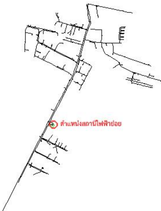
รูปที่ 4.3 โครงสร้างของสายจำหน่ายสำหรับการจ่ายไฟฟ้าไปยังผู้ใช้ไฟฟ้าในระบบจำหน่ายไฟฟ้าแรงดันปานกลาง (24 kV)
