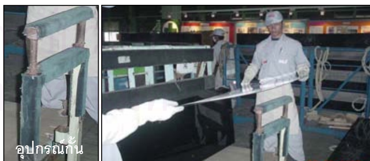
รูปที่ 4.8 แสดงอุปกรณ์กัน (Stopper) และวิธีการยกกระจกข้ามอุปกรณ์กัน
