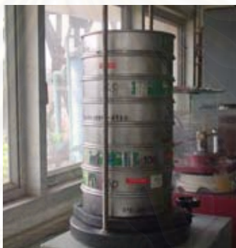
รูปที่ 4.7 แสดงเครื่องมือตรวจสอบขนาดของวัตถุดิบ (Grain size)
