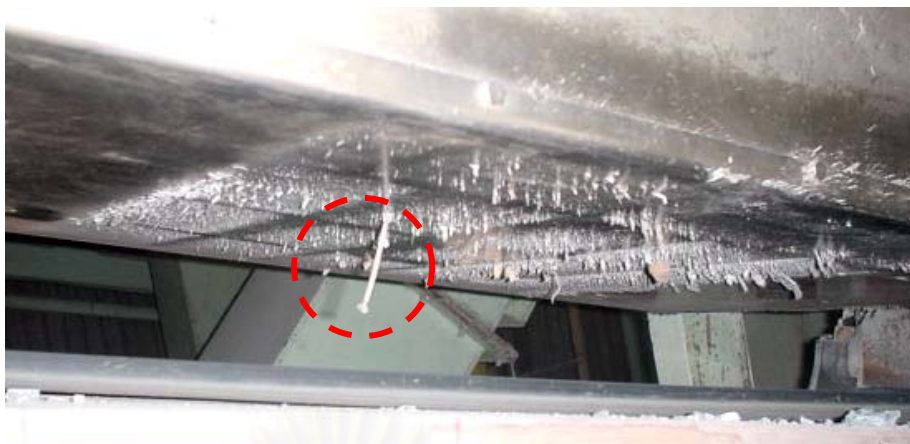
รูปที่ 4.3 แสดงแม่เหล็ก (Metal detector) เพื่อดักจับอุปกรณ์ที่ชำรุดก่อนเข้าเตาหลอม
