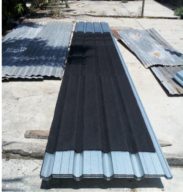
ภาพ 3.3 แผ่นเหล็กมุงหลังคาที่ติดด้วยฉนวนยางดำ
