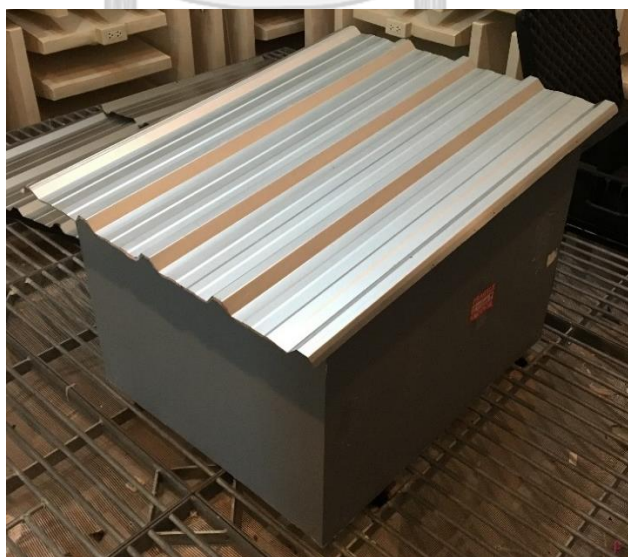
ภาพ 2.7 กล่องทดสอบในการทดสอบคุณสมบัติในการกันเสียงของฉนวนแต่ละชนิดที่ใช้กับแผ่นเหล็กมุงหลังคา
