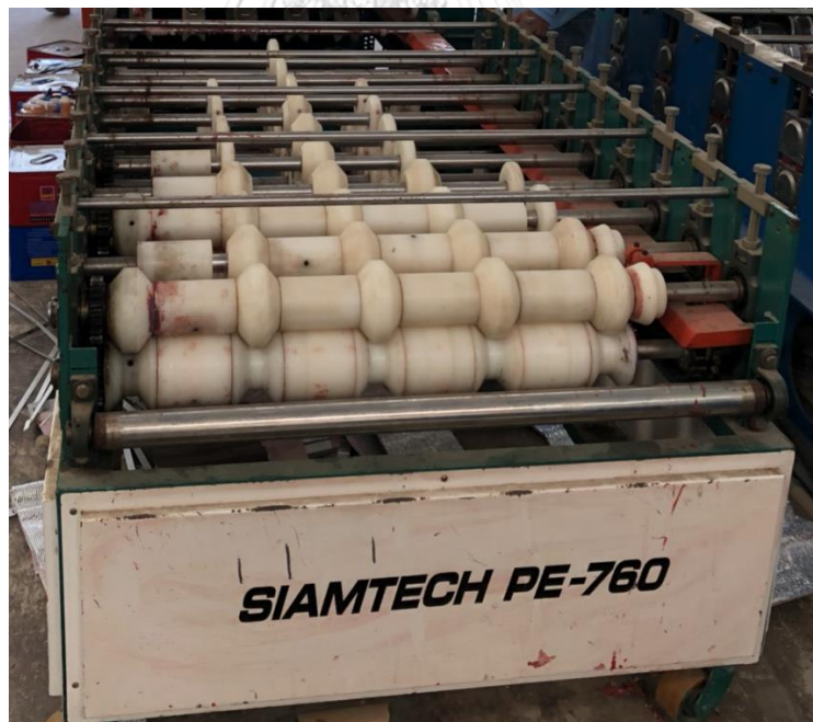
ภาพ 3.2 เครื่องจักรที่ใช้งานรีดฉนวนยางดำติดกับแผ่นเหล็กมุงหลังคา
