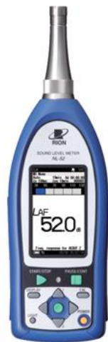
ภาพ 3.26 Sound Level Meter ยี่ห้อ RION รุ่น NL-52
