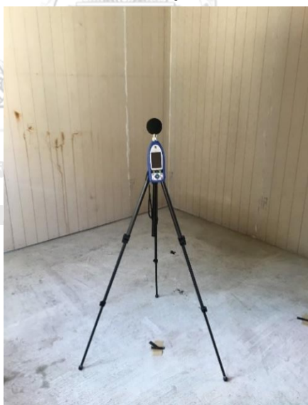
ภาพ 3.27 แสดงการติดตั้ง Sound Level Meter บริเวณกลางห้องจำลอง
