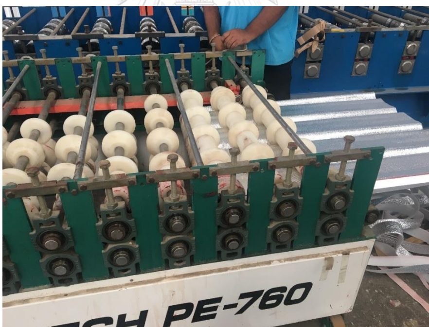
ภาพ 2.9 การรีดฉนวน PE ติดกับแผ่นเหล็กมุงหลังคาโดยใช้เครื่องรีด ที่มา : ถ่ายโดยผู้วิจัย วันที่ 24 มกราคม 2561
