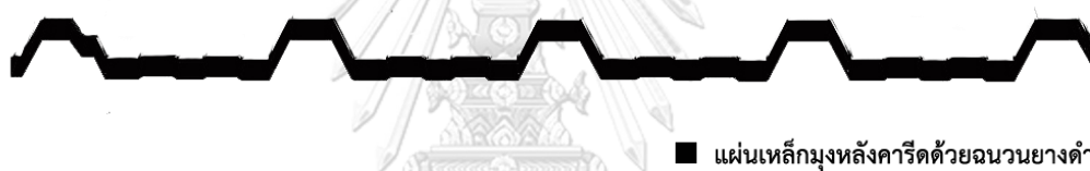
ภาพ 3.17 แสดงภาพจำลองด้านหน้าของการติดตั้งติดตั้งแผ่นเหล็กมุงหลังคาโดยใช้ฉนวนยางดำ
