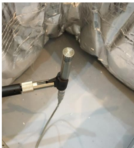
ภาพ 2.11 การวางไมโครโฟนในกล่องทดสอบคุณสมบัติในการกันเสียงของฉนวนแต่ละชนิดที่ใช้งาน กับแผ่นเหล็กมุงหลังคา ที่มา : ถ่ายโดยผู้วิจัย วันที่ 6 กุมภาพันธ์ 2561
