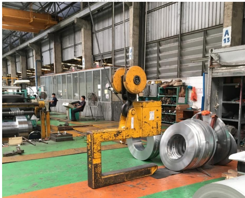
ภาพ 3.10 เครื่องยกคอยล์เหล็กชุบกำลวดาไนซ์ที่ตัดแบ่งตามแนวยาวเพื่อขนย้ายไปขึ้นรูป ที่มา : ถ่ายโดยผู้วิจัย วันที่ 5 มกราคม 2561
