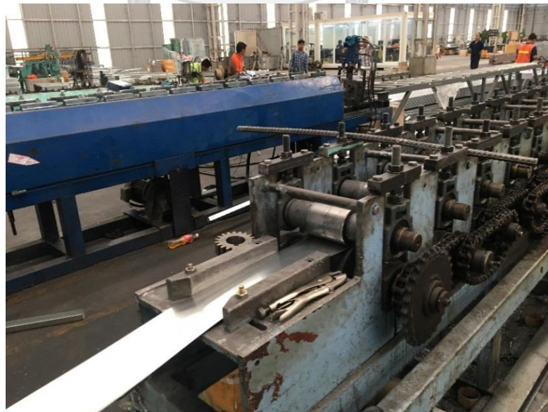
ภาพ 3.12 ขึ้นรูปแผ่นเหล็กชุบกำลวานโซโดยสายพานลูกกลิ้งเหล็ก ที่มา : ถ่ายโดยผู้วิจัย วันที่ 5 มกราคม 2561
