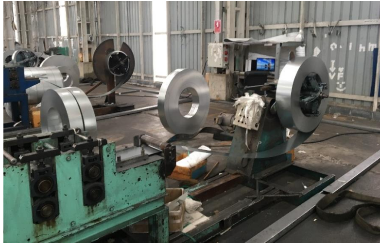
ภาพ 3.15 ล้อหมุนสำหรับติดตั้งคอล์ยเหล็กชุบักลวาไนซ์เพื่อลำเลียงแผ่นเหล็กชุบักลวาไนซ์เข้า
