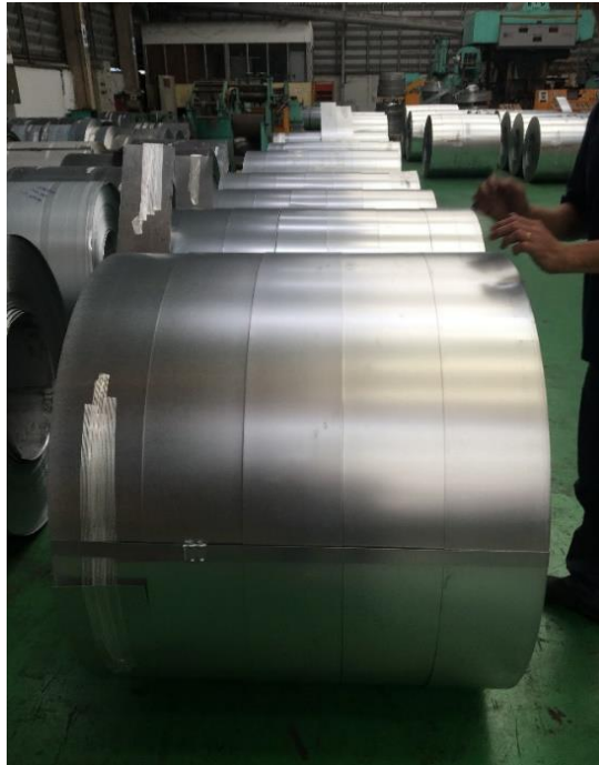
ภาพ 3.9 คอยล์เหล็กชุบกำลวดาไนซ์ที่ตัดตามแนวยาวเตรียมขนย้ายเพื่อขึ้นรูปโครงหลังคา ที่มา : ถ่ายโดยผู้วิจัย วันที่ 5 มกราคม 2561
