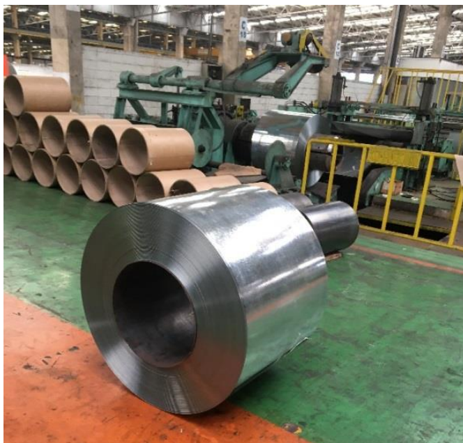
ภาพ 3.5 คอยล์เหล็กชุบกำลวไนซ์ก่อนที่จะทำการตัดแบ่งตามแนวยาว ที่มา : ถ่ายโดยผู้วิจัย วันที่ 5 มกราคม 2561
