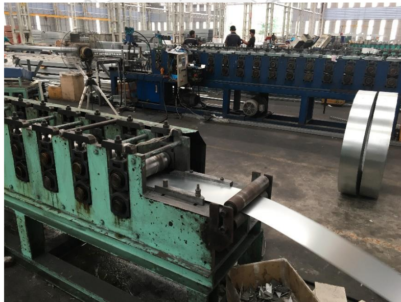
ภาพ 3.16 ขึ้นรูปแผ่นเหล็กชุบักลวาไนซ์โดยลูกกลิ้งเหล็ก
