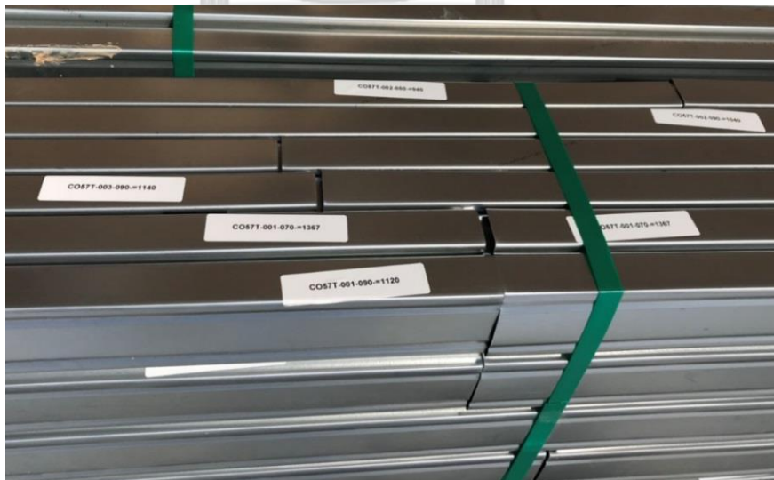
ภาพ 3.18 เครื่องหมายระบุขนาดและความยาวของชิ้นส่วนเหล็กชุบกัลวาไนซ์ในการประกอบและติดตั้ง
