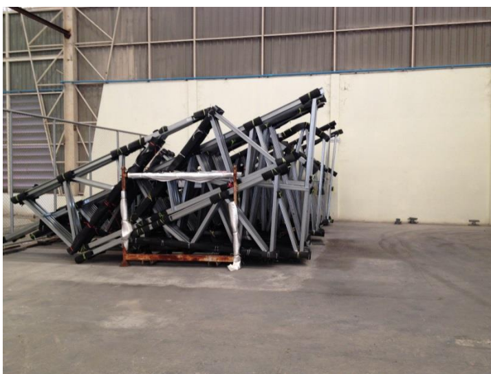
ภาพ 5.53 โครงถักสำเร็จรูปที่ประกอบที่โรงงาน ที่มา : บริษัท ปูนซิเมนต์ไทย จำกัด (มหาชน)
