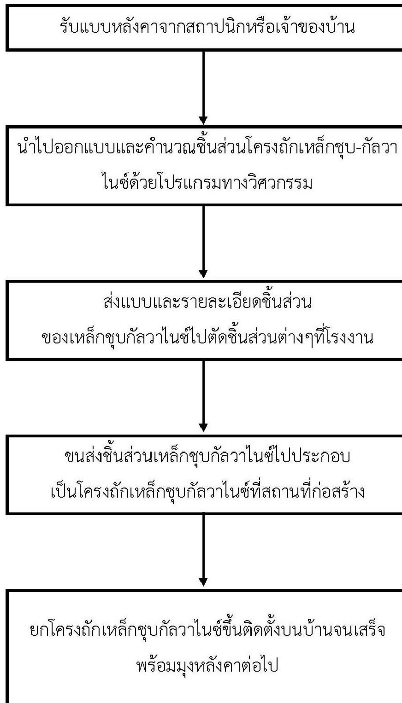
แผนภูมิ 3.1 ขั้นตอนการดำเนินงานผลิตชิ้นส่วนเหล็กชุบกัลวาไนซ์ ที่มา : บริษัท ปูนซิเมนต์ไทย จำกัด (มหาชน)
