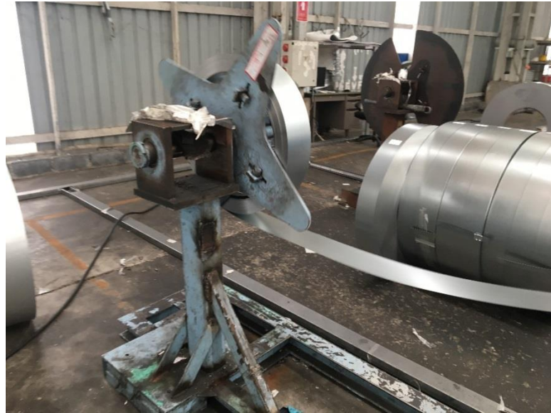
ภาพ 3.11 ล้อหมุนสำหรับติดตั้งคอยล์เหล็กชุบกำลวานโซเพื่อลำเลียงแผ่นเหล็กชุบกำลวานโซเข้าเครื่องจักร
