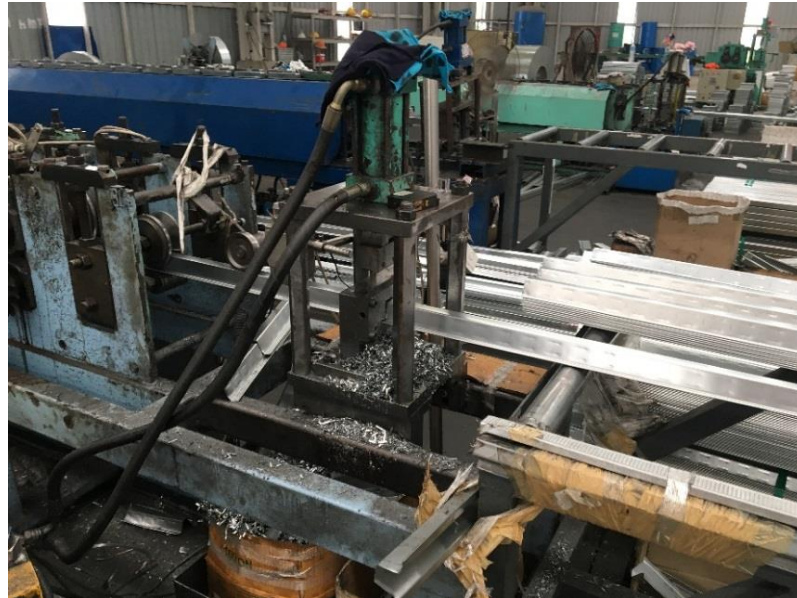
ภาพ 3.13 ชิ้นส่วนแปเหล็กชุบกัลวาไนซ์ขึ้นรูปโดยเครื่องจักร ที่มา : ถ่ายโดยผู้วิจัย วันที่ 5 มกราคม 2561
