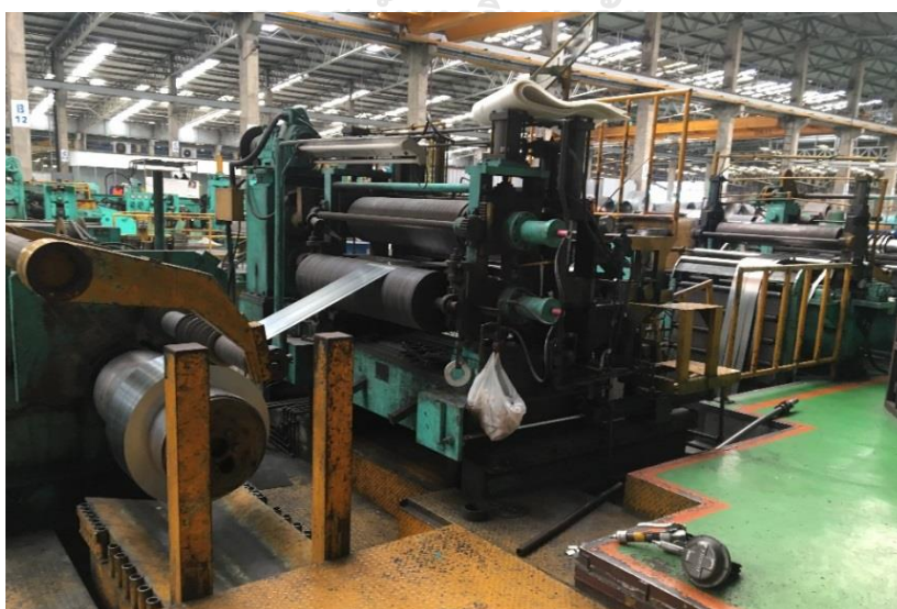
ภาพ 3.6 การทำงานของเครื่องจักรในขณะทำการตัดแบ่งเหล็กชุบกำลวไนซ์ตามแนวยาว ที่มา : ถ่ายโดยผู้วิจัย วันที่ 5 มกราคม 2561
