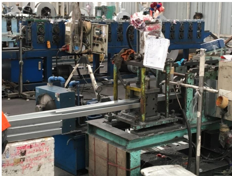
ภาพ 3.19 ชิ้นส่วนเหล็กชุบกำลวาน้ำหนักตัดตัวซีขึ้นรูปโดยเครื่องจักร ที่มา : ถ่ายโดยผู้วิจัย วันที่ 5 มกราคม 2561
