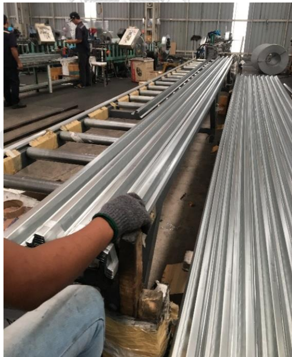
ภาพ 3.14 ชิ้นส่วนแปเหล็กชุบกัลวาไนซ์จากการขึ้นรูปโดยเครื่องจักร ที่มา : ถ่ายโดยผู้วิจัย วันที่ 5 มกราคม 2561
