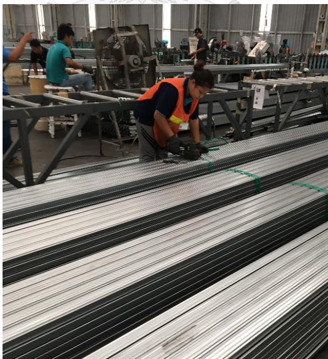
ภาพ 3.20 ทำการมัดชิ้นส่วนเหล็กชุบกำลวาน้ำหนักเพื่อขนย้ายขึ้นรถบรรทุกไปยังสถานที่ก่อสร้าง ที่มา : ถ่ายโดยผู้วิจัย วันที่ 5 มกราคม 2561
