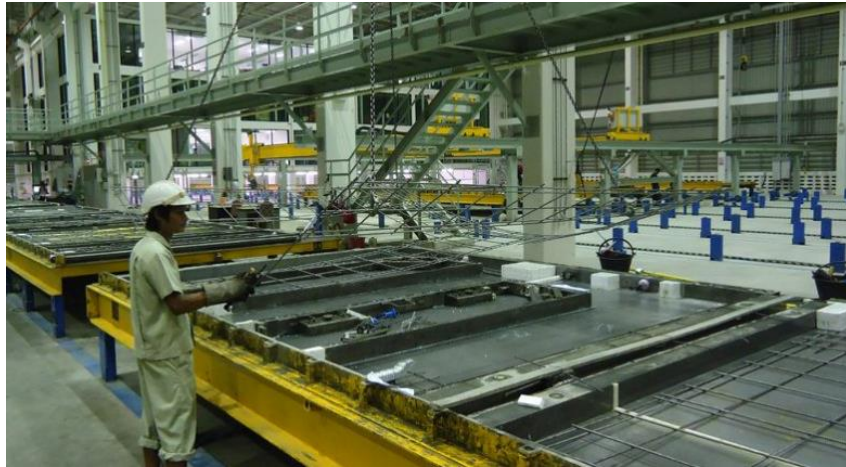
ภาพที่ 41 การวางตะแกรงเหล็กเสริมของชั้นส่วนผนังคอนกรีตสำเร็จรูป
