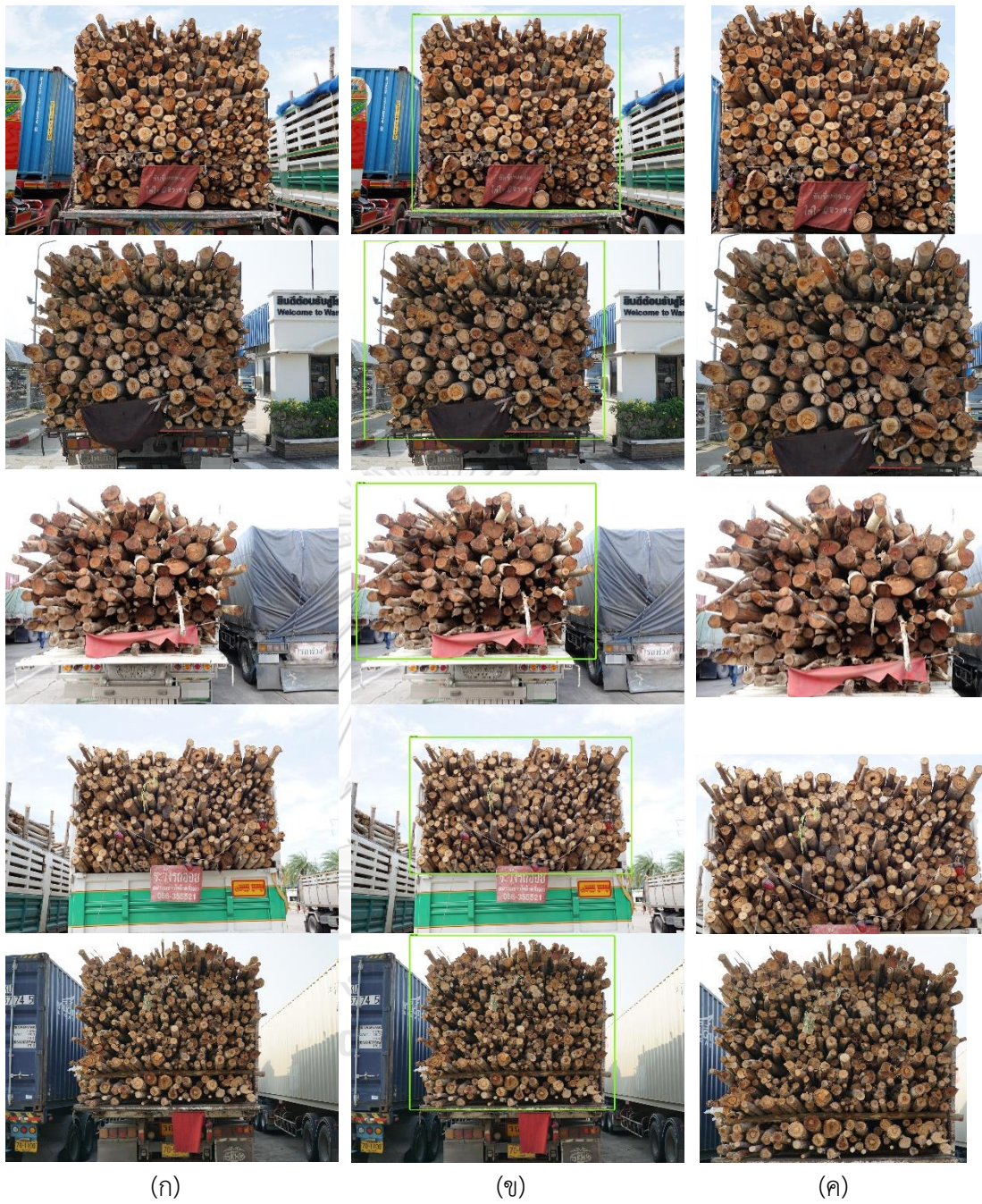
รูปที่ 4-9 ภาพผลลัพธ์ของวิธีการตรวจจับรถบรรทุกไม้ยูคาลิปด้วยด้วยโครงสร้าง SSD (ก) ภาพทดสอบ (ข) ภาพผลลัพธ์จากการทดสอบ (ค) ภาพผลลัพธ์จากการตัดภาพส่วนเฉพาะด้านท้ายรถบรรทุกไม้ในภาพโดยอ้างอิงจากพิกัดของกรอบสี่เหลี่ยมในการปิดล้อมวัตถุ
