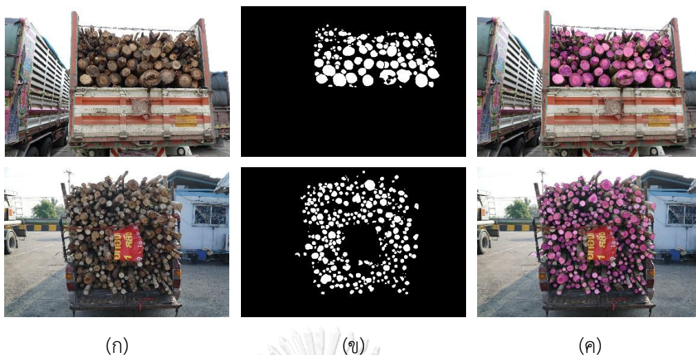
รูปที่ 4-15 ภาพผลลัพธ์ของวิธีการแยกส่วนหน้าตัดของปลายท่อนซุงด้วยแบบจำลอง VGG16 (ก) ภาพทดสอบ (ข) ภาพผลลัพธ์ของกระบวนการแยกส่วนหน้าตัดของปลายท่อนซุง (ค) ภาพผลลัพธ์จากการแยกส่วนหน้าตัดของปลายท่อนซุงวางทับบนภาพทดสอบ (ต่อ)
