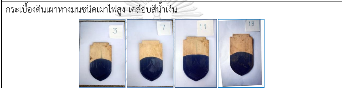
ภาพที่ 112 ตัวอย่างกระเบื้องดินเผาทางมนชนิดเผาธรรมดา และชนิดเผาไฟสูง
