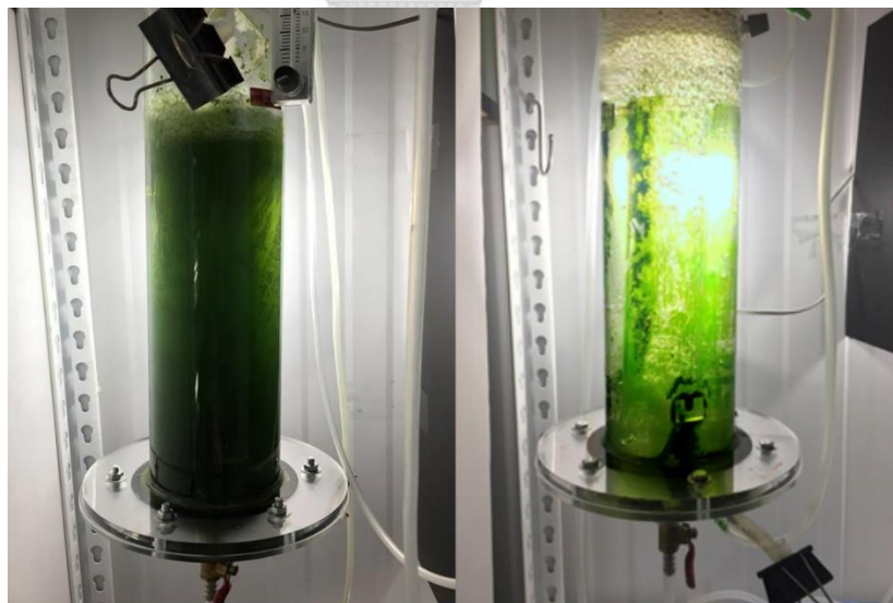
รูปที่ 4.21 การเกาะติดที่ผนังของถังปฏิกรณ์ที่อัตราการไหลของอากาศ 0.8 วีวีเอ็ม (ข้าว) และ 1.6 วีวีเอ็ม (ข้าว)
