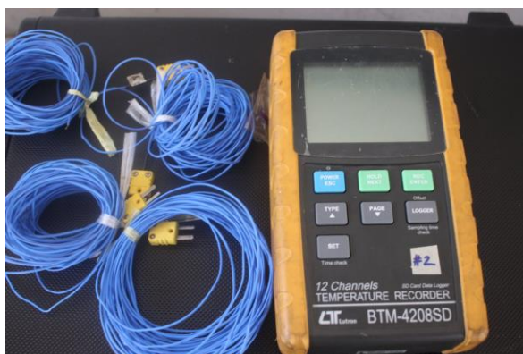
ภาพที่ 3.10 เครื่องมือวัดอุณหภูมิ 12 Chanel และสายเซนเซอร์วัดอุณหภูมิ
