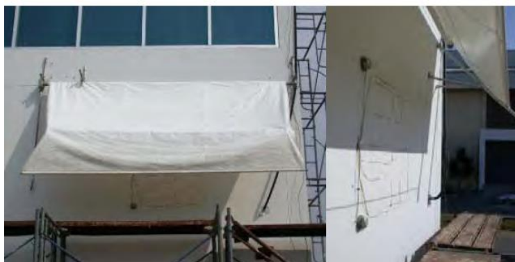
ภาพที่ 2.7 การติดตั้งเครื่องมือวัดผลและการติดตั้งอุปกรณ์บังแดด
