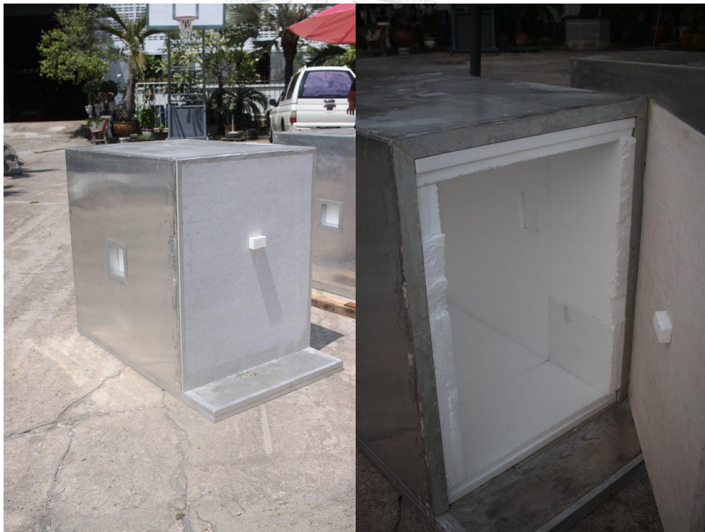
ภาพที่ 3.8 ลักษณะกล่องทดลองที่บุด้านในด้วยโฟม และปิดทับด้านที่ทำการทดลองด้วยแผ่นสมาร์ทบอร์ดหนา 8 มิลลิเมตร
