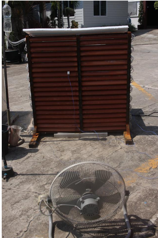
ภาพที่ 3.17 การติดตั้งพัดลมหน้าแผงกันแดดในทดลองที่2
