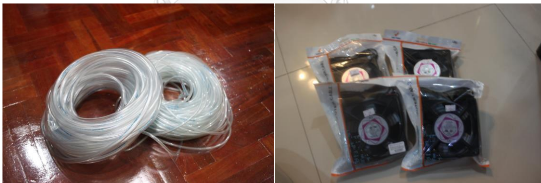
ภาพที่ 3.6 (ภาพซ้าย) สายยางยี่ห้อท่อน้ำไทยขนาดเส้นผ่าศูนย์กลาง 10 มิลลิเมตรและ 5 มิลลิเมตร (ภาพขวา) พัดลมระบายอากาศที่ใช้ในการทดลอง
