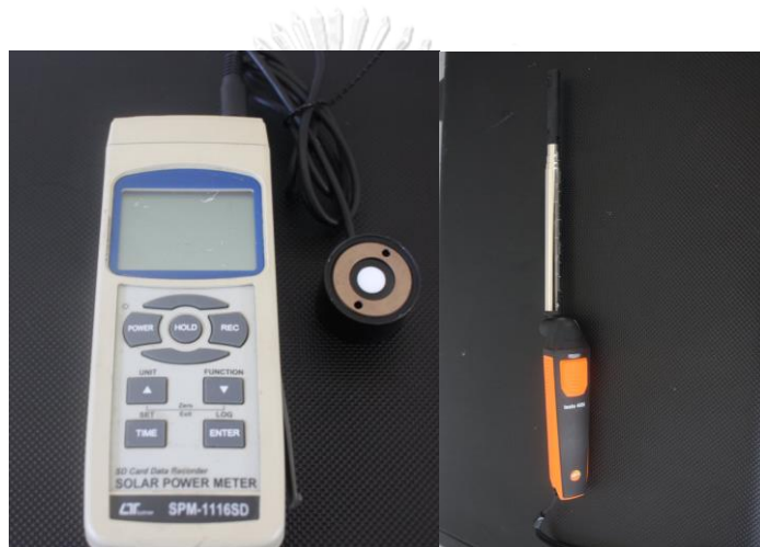
ภาพที่ 3.13 เครื่องมือวัดรังสีดวงอาทิตย์ SPM-1116SD และ เครื่องมือวัดความร้อน Testo 405i
