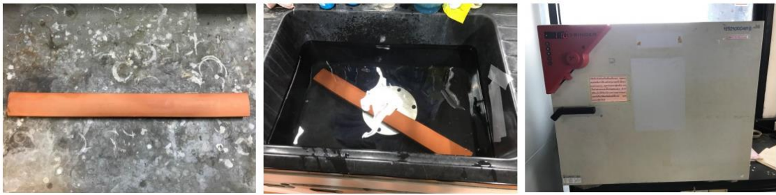
ภาพที่ 3.2 การทดสอบหาค่าดูดซึมน้ำในเนื้อวัสดุ ณ วันที่ 24 ตุลาคม พ.ศ.2560
