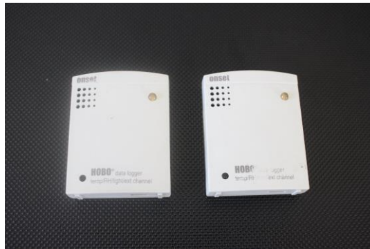
ภาพที่ 3.12 เครื่องมือวัดอุณหภูมิและความชื้นสัมพัทธ์ HOBO
