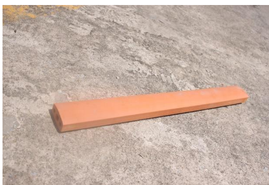
ภาพที่ 3.1 แท่งดินเผาที่นำมาใช้ในการทดลอง ยี่ห้อ อปก.รุ่น119/60
