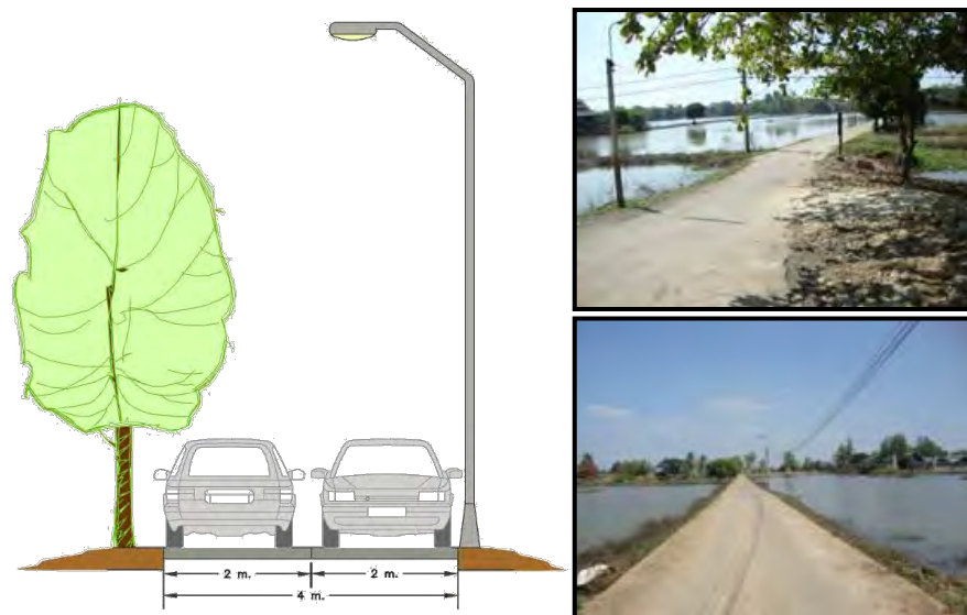
ภาพที่ 4.17 ถนนประเภทที่ 3 (แบบที่ 2) ภายในพื้นที่ศึกษา
