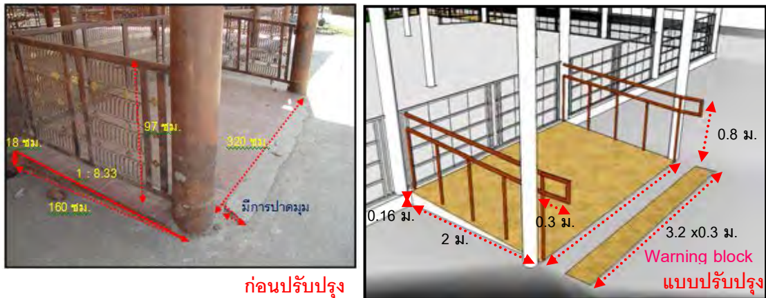
ภาพที่ 6.2 การปรับปรุงพื้นที่ทางลาดด้านหน้าศาลาอเนกประสงค์ วัดท่าอิฐ
