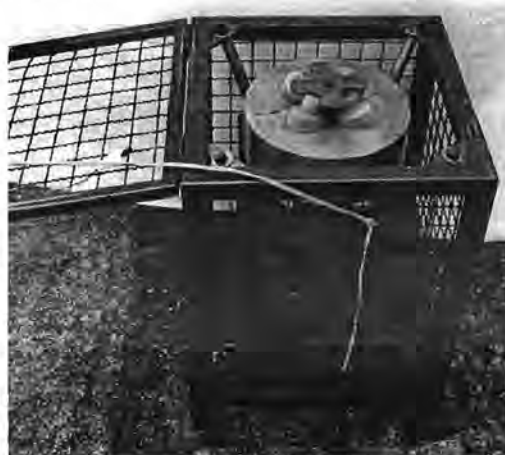
ภาพที่ 4 เครื่องสกัดเหวี่ยงแยกน้ำมันปาล์ม ชนิดไม่อิมตัว (CPOL) และชนิดอิมตัว (CPS)
