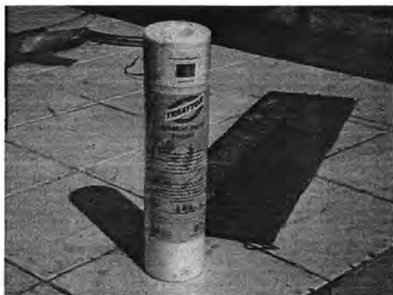
ภาพที่ 17 ใส้กรองของเครื่องกรองน้ำมันปาล์ม ก่อนใช้งาน และ หลังใช้กรองน้ำมันปาล์ม
