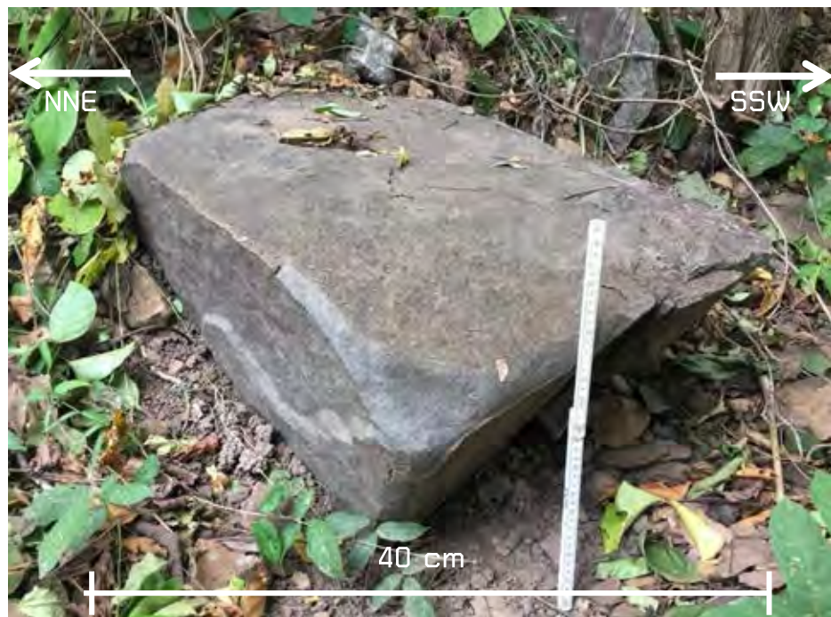
รูปที่ 5.4 แสดงหินที่ร่วงลงอยู่ตามบริเวณหน้าลาดเอียงหิน
