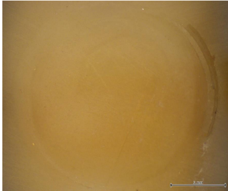
รูปที่ 16 แสดงภาพกำลังขยาย 40 เท่าบนด้านเนื้อฟันที่แตกหักของกลุ่ม C&B™ CEMENT ที่ระยะเวลา 1 ชั่วโมง ซึ่งมีการแตกหักบริเวณรอยต่อระหว่างเนื้อฟันและเรซินซีเมนต์ (adhesive fracture)
