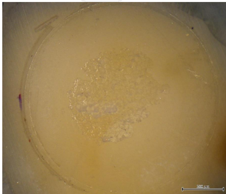
รูปที่ 19 แสดงภาพกำลังขยาย 40 เท่าบนด้านเนื้อฟันที่แตกหักของกลุ่ม C&B™ CEMENT ที่ระยะเวลา 24 ชั่วโมง ที่มีการแตกหักบริเวณรอยต่อระหว่างเนื้อฟันและเรซินซีเมนต์ร่วมกับการแตกหักในเรซินซีเมนต์ และ/หรือในเนื้อฟัน (mixed fracture)
