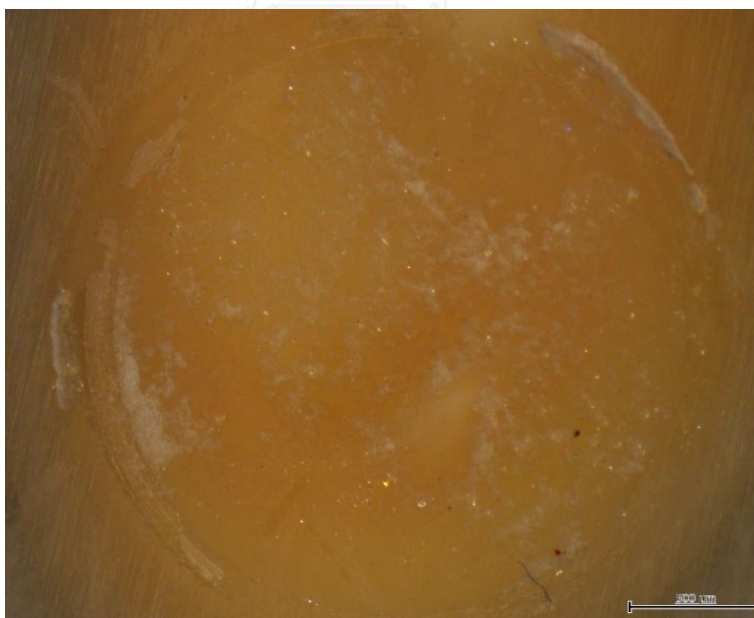
รูปที่ 15 แสดงภาพกำลังขยาย 40 เท่าบนด้านเนื้อฟันที่แตกหักของกลุ่ม Super Bond C&B® ที่ระยะเวลา 24 ชั่วโมง ที่มีการแตกหักบริเวณรอยต่อระหว่างเนื้อฟันและเรซินซีเมนต์ร่วมกับการแตกหักในเรซินซีเมนต์ และ/หรือในเนื้อฟัน (mixed fracture)
