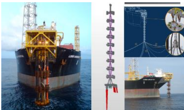
ภาพที่ 2.11 สิ่งติดตั้งใต้ทะเลที่เกี่ยวข้องกับเรือ (Turret) ที่มา: ปตท.สำรวจและผลิตปิโตรเลียม (2554)
