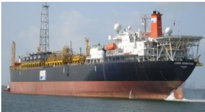
ภาพที่ 2.10 เรือกักเก็บและผลิตปิโตรเลียม ลีเว็ค อรุโณทัย ที่มา: ปตท.สำรวจและผลิตปิโตรเลียม (2554)
