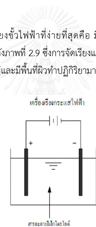
ภาพที่ 2.9 การจัดเรียงขั้วไฟฟ้าโมโนโพลาร์เซลล์เดี่ยว (Pretorius และคณะ, 1991)
