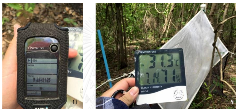
ภาพที่ 22 แสดงเครื่อง GPS ยี่ห้อ Garmin รุ่น eTrex 30 (ก) และเครื่อง HTC-2 digital Hygro – thermometer สำหรับวัดอุณหภูมิและความชื้น (ข)
