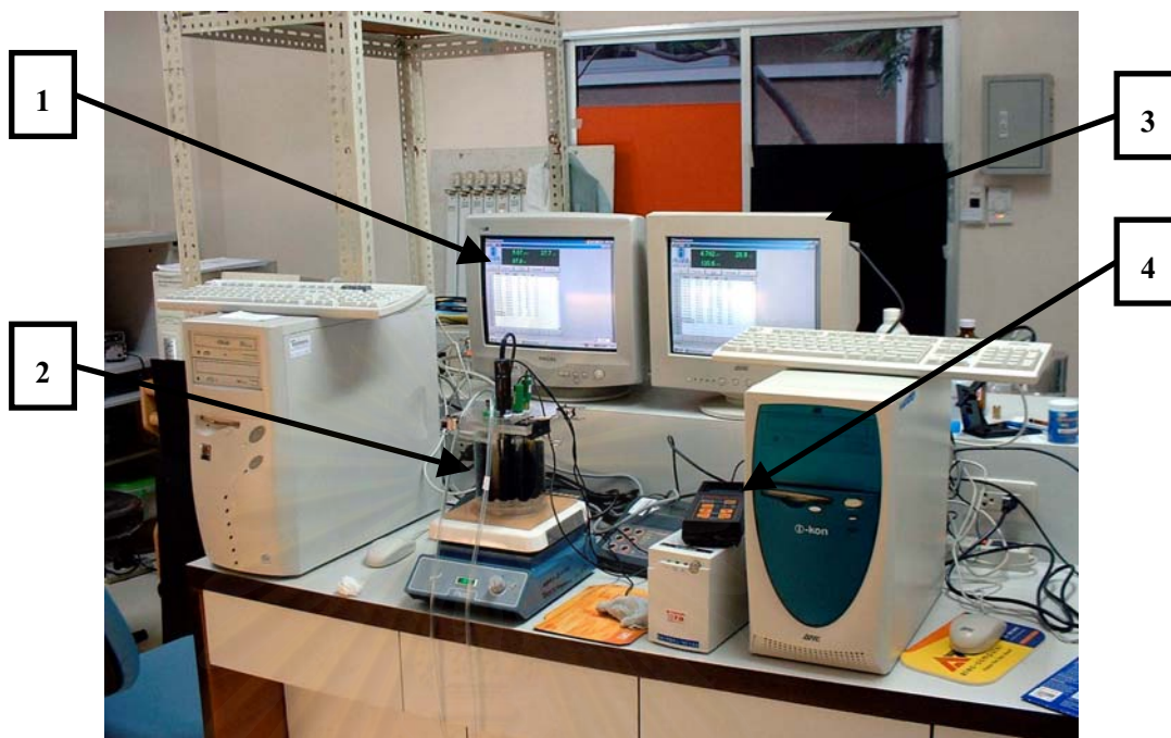
ภาพที่ 3-3 เครื่องมือที่ใช้ในการศึกษาอัตราการใช้ออกซิเจนของแบคทีเรีย อัตราการเกิดปฏิกิริยาดีในตรีฟิเคชัน และการเกิดไฮโดรเจนซัลไฟด์ของระบบบำบัดไนเตรทที่ใช้วัสดุกรองทรงกลม (bioball) ในสถานะห้องปฏิบัติการ โดยมีการเก็บข้อมูลแบบอัตโนมัติ
