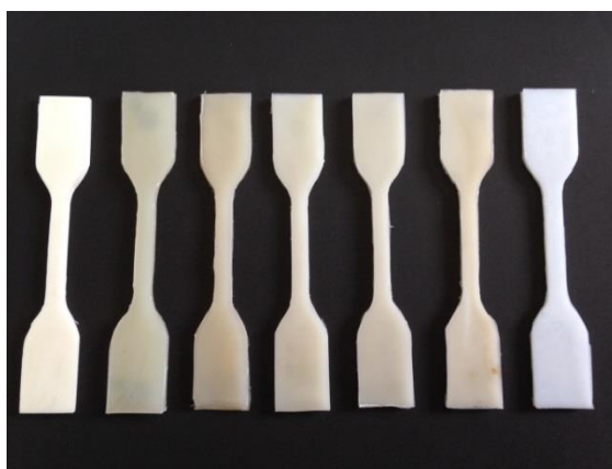
รูปที่ 3.8 ชิ้นทดสอบสำหรับทดสอบความทนแรงดึง
