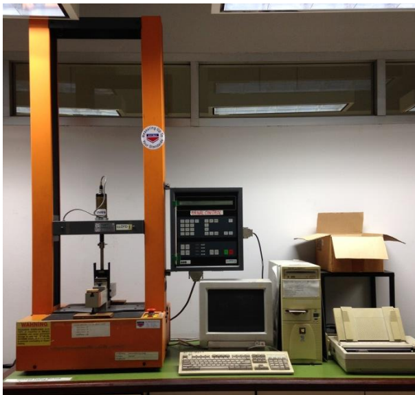
รูปที่ 3.11 เครื่องมือทดสอบความทนแรงดัดโค้ง
