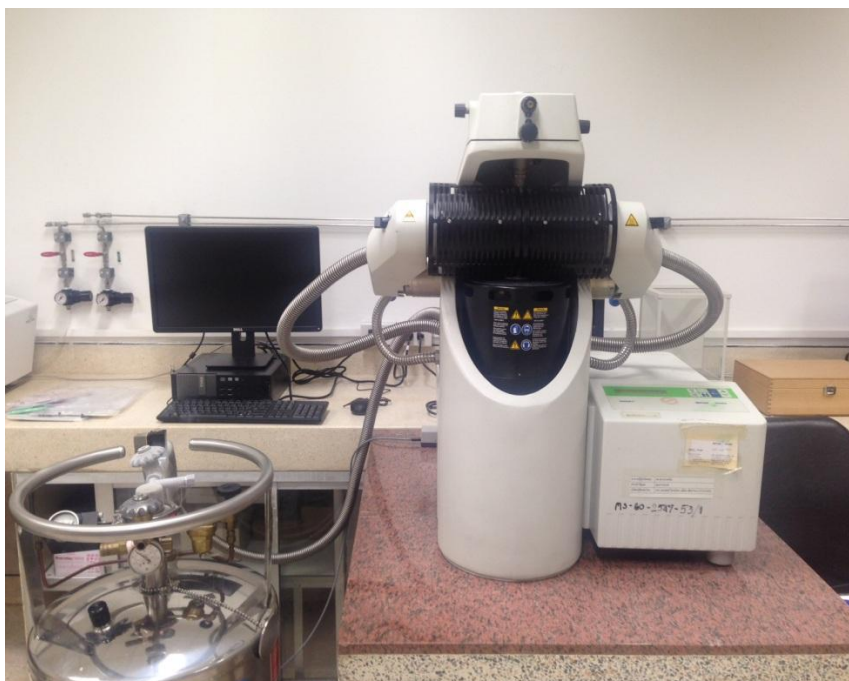
รูปที่ 3.18 เครื่องวิเคราะห์สมบัติกลพลวัต (DMA/SDTA861 ๕ )
