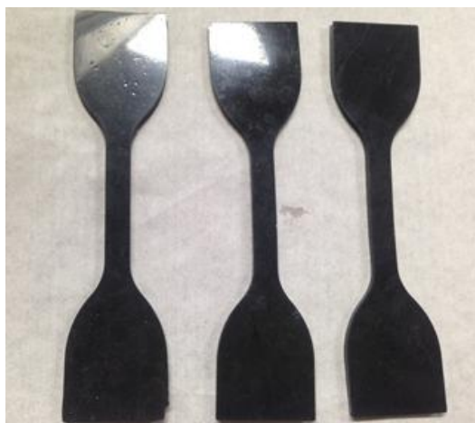
รูปที่ ๑๐-10 ตัวอย่างชิ้นทดสอบรูปดัมเบลล์ ที่ใช้ในการทดสอบสมบัติเชิงกลในเทอมของความทนแรงดึง, มอดุลัสที่ความเครียด 300% และการยืด ณ. จุดขาดของยางธรรมชาติ, ยาง ENR-30 และยาง ENR-30/CNT นาโนคอมพอสิต
