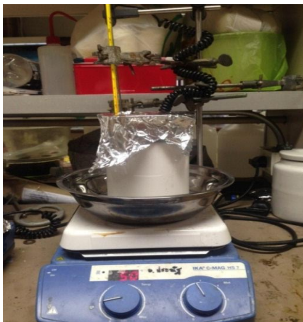
รูปที่ 3.1 อุปกรณ์ที่ใช้เตรียมยางธรรมชาติฟ็อกซิไดซ์
