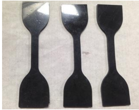
รูปที่ 4.4 ชิ้นงานรูปดัมเบลล์ที่ใช้ทดสอบสมบัติด้านความทนแรงดึง
