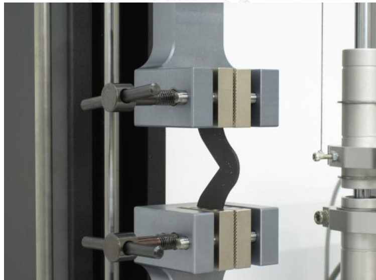
รูปที่ 3.15 หัวจับที่ใช้ดึงขึ้นทดสอบเพื่อหาความทนแรงฉีกขาด
