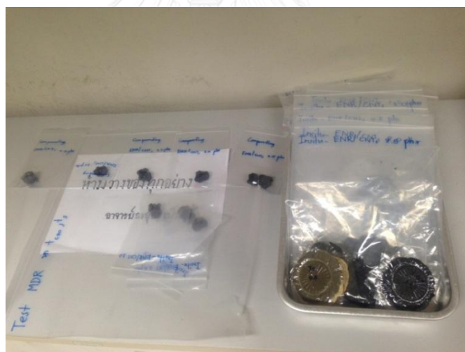
รูปที่ ๑๐-10 ตัวอย่างชิ้นในการทดสอบ Cure characteristics ด้วยเครื่อง MDR ของยางธรรมชาติ, ยาง ENR-30 และยาง ENR-30/CNT นาโนคอมพอสิต
