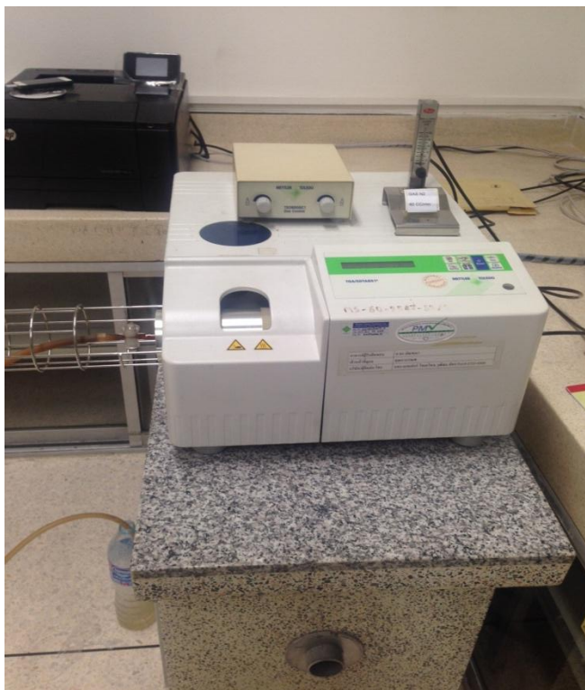
รูปที่ 3.17 เครื่องวิเคราะห์น้ำหนักภายใต้ความร้อน (ทีจีเอ)(TGA/SDTA 851 ๕ )
