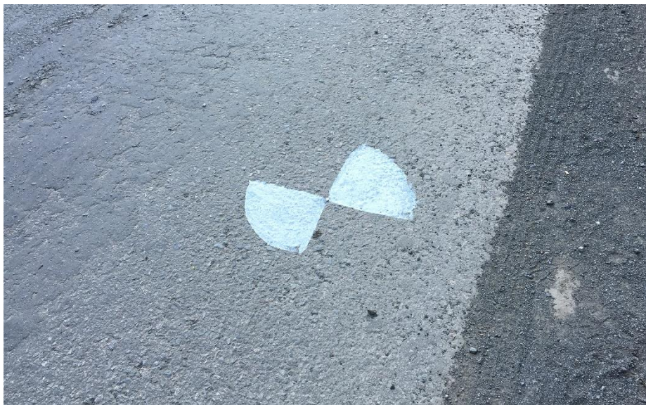
รูปที่ 6.7 ตัวอย่างจุด BM ของโครงการก่อสร้างที่ทาสีขาวชั่วคราวในพื้นที่กรณีศึกษา
