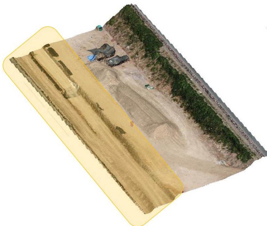
รูปที่ 6.11 ส่วนหนึ่งของแบบจำลองพื้นผิวภูมิประเทศเชิงเลขจากระบบที่นำเสนอจากการเก็บข้อมูลครั้งที่ 3
