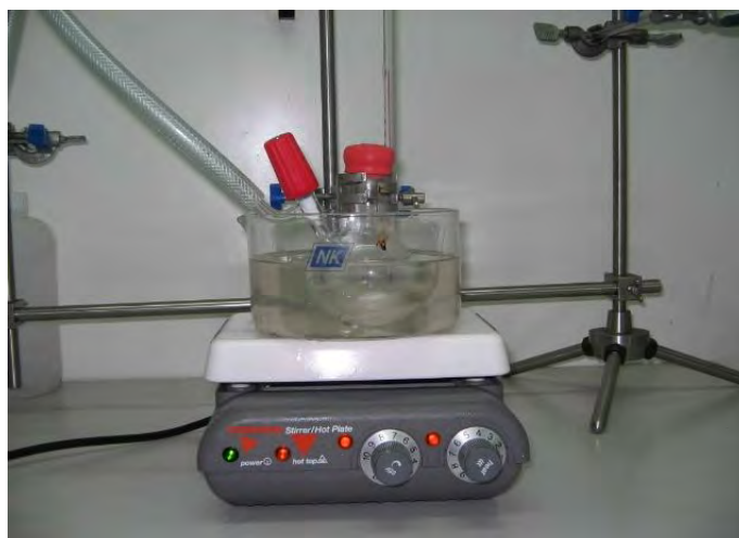
รูปที่ 3.2 การติดตั้งอุปกรณ์สำหรับสังเคราะห์เอสเทอร์พรีเคอร์เซอร์
