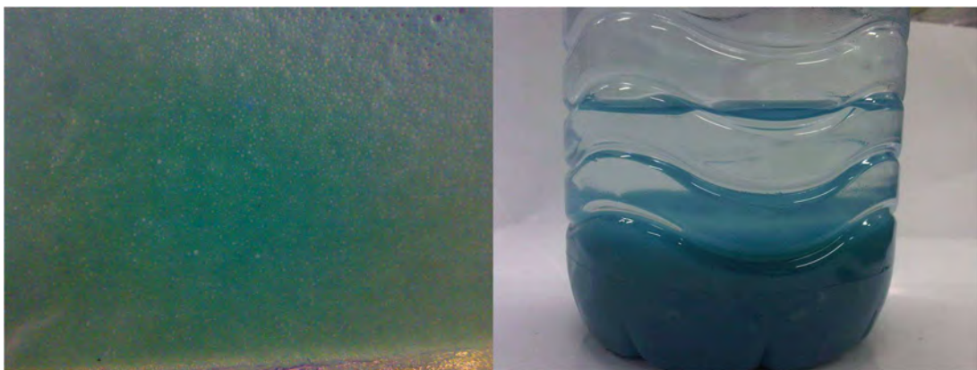
รูปที่ 4.7 ตะกอนจากการเดินระบบด้วยขั้วทองแดง—ขั้วแกรไฟต์ (ก) ตะกอนลอยบริเวณผิวน้ำ (ข) ตะกอนที่ก้นภาชนะ
