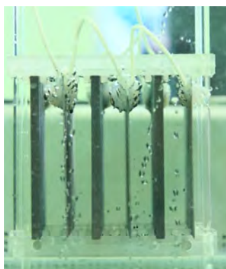
รูปที่ 3.3 การจัดเรียงขั้วอิเล็กโทรดแบบโมโนโพลาร์หลายเซลล์แบบขนาน
