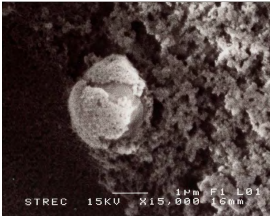
รูปที่ 4.25 สำหรับถ่ายห่อหุ้มด้วยอะลูมิเนียมไฮดรอกไซด์ผ่านกลไกการตกตะกอนแบบกวาด (วิเคราะห์ด้วยกล้องจุลทรรศน์อิเล็กตรอนที่กำลังขยาย 15,000 เท่า)
