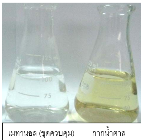
รูปที่ 4.14 ลักษณะและสีของน้ำหลังการบำบัดไนเตรตจากชุดที่เติมเมทานอล (ชุดควบคุม) และกากน้ำตาลเป็นสารอินทรีย์คาร์บอน
