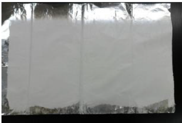
รูปที่ 4.11 ผืนเส้นใยอิเล็กโทรสปินที่เตรียมได้ (57 cm x 97.3 cm) จากการฉีดเส้นใยอย่างต่อเนื่องเป็นเวลา 2 ชั่วโมง
