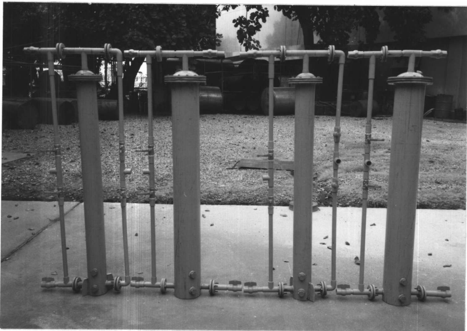
รูปที่ ค. 3 ภาพถ่ายหอทดลองก่อนติดตั้งระบบท่อ
