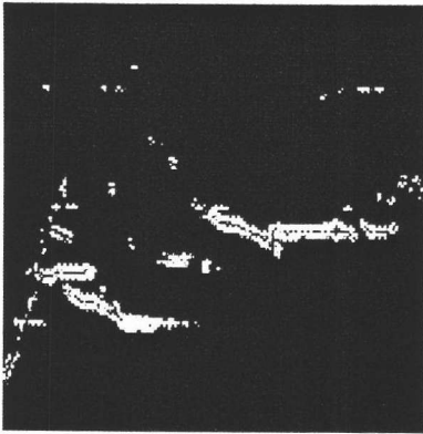
รูปที่ 3.7 m. ภาพหลังผ่านการหาขอบภาพ ที่ระดับเทรชโฮลด์เท่ากับ 15
