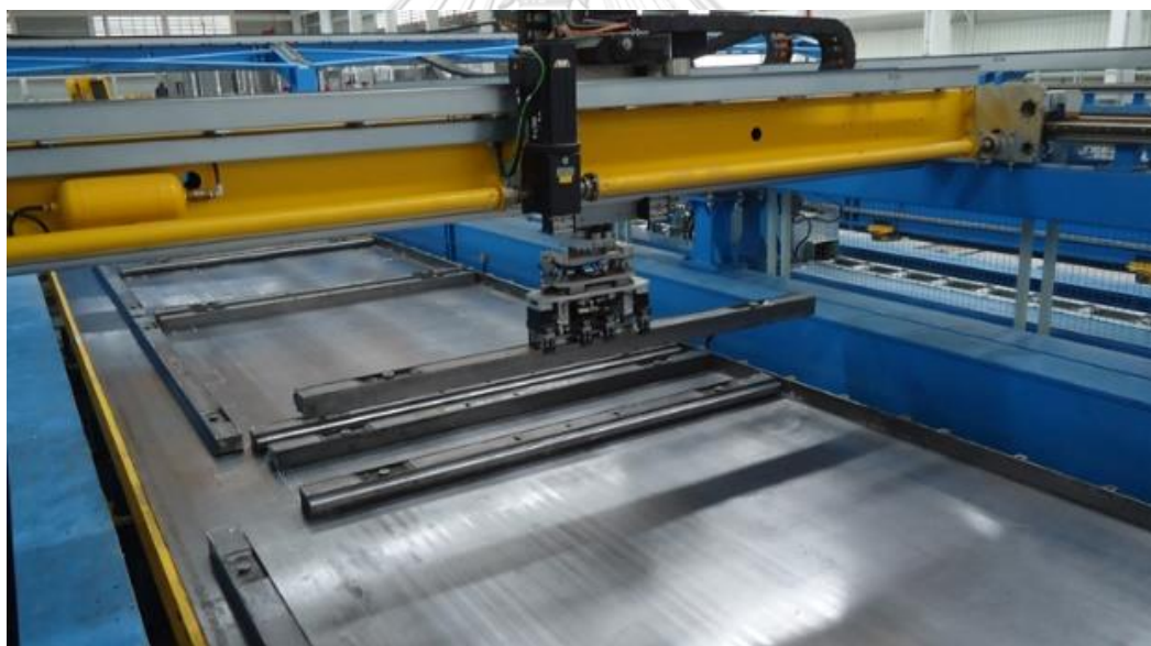
ภาพที่ 34 การวางแบบข้างเหล็กบนโต๊ะแบบ
