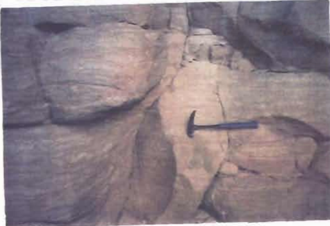
รูป 4.1 ชั้นหินทรายเนื้อละเอียดมาก-หินทรายแป้งมีเนื้อปูนผสม (ล่าง) ถูกวางทับด้วยหินทรายเนื้อหยาบปานกลาง-ละเอียด (บน), หมูหิน B
