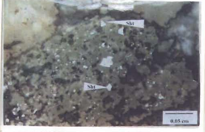
รูป 4.20 เม็ดแร่ฮีมาไทต์ (Ht) ซึ่งมีเหลี่ยมมุมแทรกตามเนื้อหินในหินภูพานร่วมกับตัวเชื่อมประสานจำพวกเหล็กออกไซด์ (FeO) (X-nicols in polish-section)
