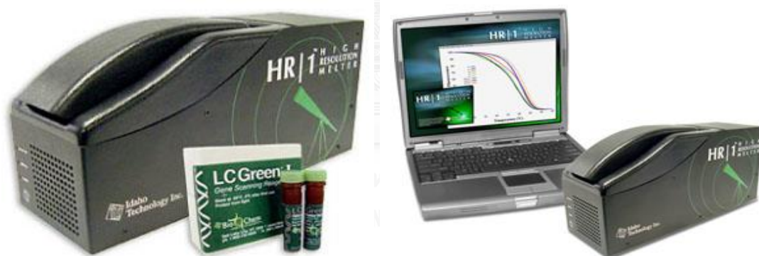
ภาพที่ 1 เครื่องตรวจ HRMA รุ่น HR-1 ของบริษัท Idaho Technology เป็นเครื่องที่มีความสามารถในการตรวจ HRMA ได้ละเอียดสูงสุดในบรรดาเครื่องตรวจ HRMA ที่มีอยู่ในตลาด
