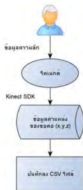
ภาพที่: 3-1 ขั้นตอนการทำงาน ของโปรแกรมบันทึกตำแหน่ง
