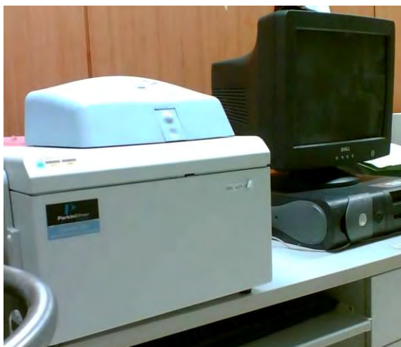
รูปที่ 3.9 เครื่องดิฟเฟอเรนเชียลสแกนนิ่งแคลอริมิเตอร์ (Perkin-Elmer, DSC 7)
