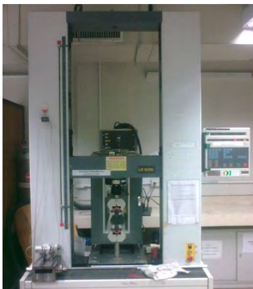
รูปที่ 3.4 เครื่องทดสอบยูนิเวอร์แซล (LLOYD LR 100K)
