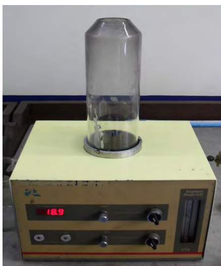
รูปที่ 3.11 เครื่องวัดดัชนีออกซิเจนจำกัด (Stanton Redcroft)
