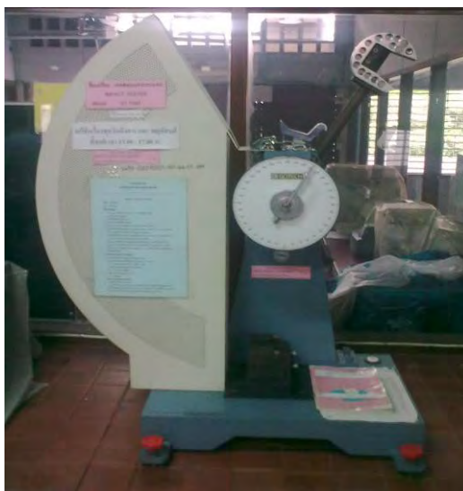
รูปที่ 3.7 เครื่องทดสอบความทนแรงกระแทกแบบ Charpy (Gotech GT-7045)
