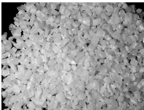
รูป ก-4 โพลีโพรพิลีน/เอทิลีนออกทีน โคโพลีเมอร์ที่ได้จากการอัดรีดผ่าน หัวดายรูปวงกลม
