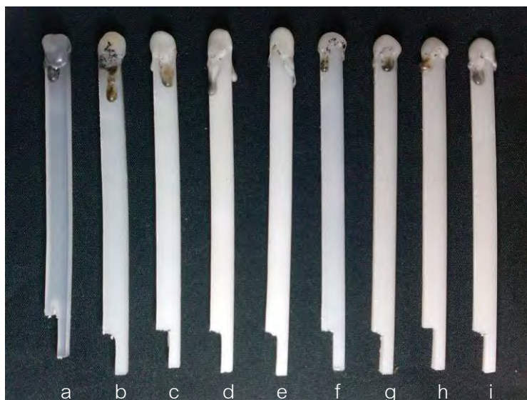
รูป ซ-2 ชิ้นงานพอลิโพรพิลีนคอมพอสิตหลังนำไปทดสอบหาค่าดัชนีออกซิเจนจำกัด
