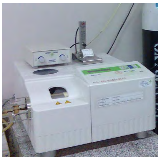
รูปที่ 3.10 เครื่องวิเคราะห์น้ำหนักภายใต้ความร้อน (ทีจีเอ) (Mettler Toledo, TGA/SDTA 851°)
