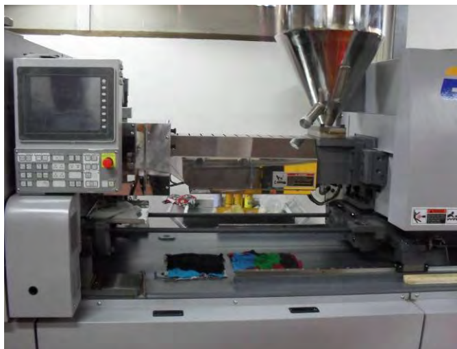
รูปที่ 3.3 เครื่องฉีดแบบ (Toshiba machine EC 130S)
