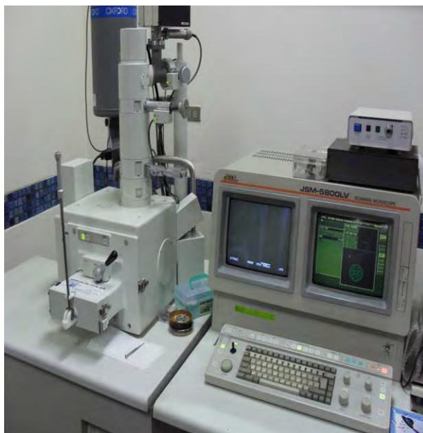
รูปที่ 3.12 กล้องจุลทรรศน์อิเล็กตรอนแบบส่องกราด (Jeol, JSM 5800 LV)
