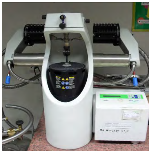
รูปที่ 3.8 เครื่องวิเคราะห์สมบัติเชิงกลพลวัต (Mettler Toledo, DMA 861°)
