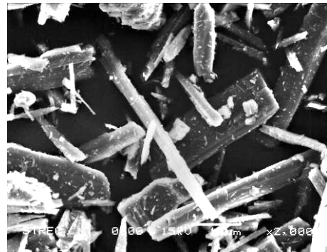
รูป ฅ-20 ภาพถ่ายโพลลอสไทน์ ที่กำลังขยาย 2000 เท่า
