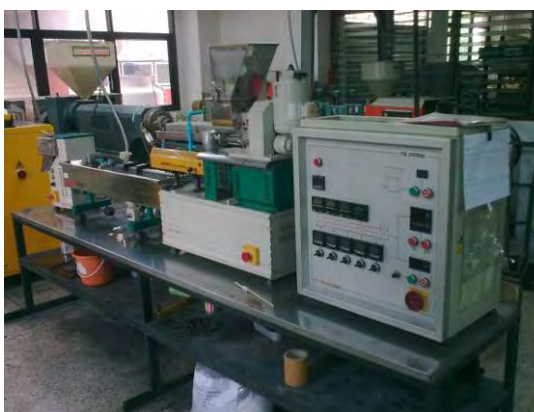
รูปที่ 3.2 เครื่องอัดรีดแบบสกรูคู่ (Thermo prism)
