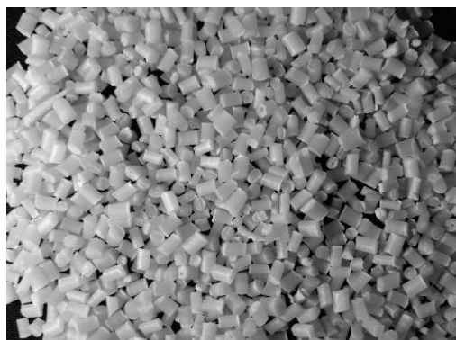
รูป ก-5 โพลีโพรพิลีน/เอทิลีนออกทีน โคโพลีเมอร์/โวลลาสโทไนต์คอมพอสิตที่ได้ จากการอัดรีดผ่านหัวดายรูปวงกลม
