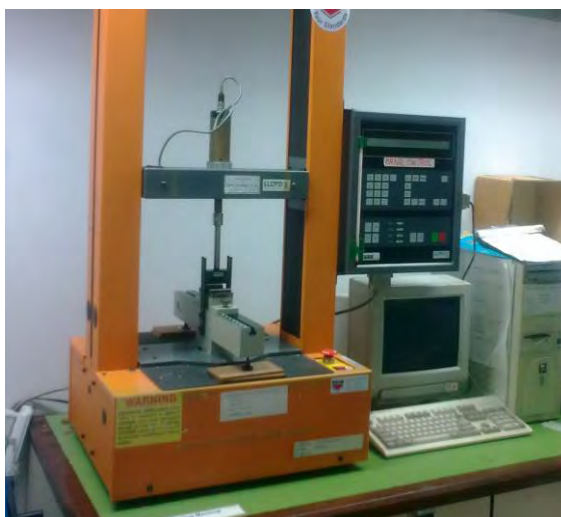
รูปที่ 3.6 เครื่องทดสอบยูนิเวอร์แซล (LLOYD 500)
