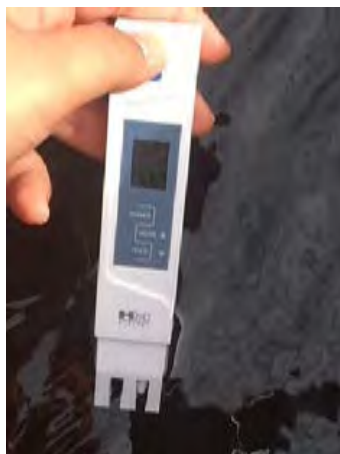
รูปที่ 3.1 วัดอุณหภูมิและค่าการนำไฟฟ้าด้วย conductivity meter
