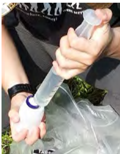
รูปที่ 3.8 เก็บตัวอย่างน้ำ สำหรับไอออนบวก
