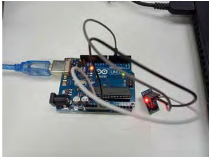
รูปที่ 2.11 การจัดตั้งอุปกรณ์เพื่อทดสอบเซนเซอร์ DS18B20
