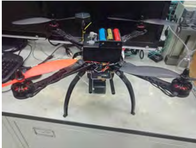
รูปที่ 3.9 การติดตั้งอุปกรณ์ตรวจวัดบนโดรน
