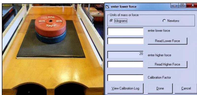
รูปที่ 12 วางแผ่นน้ำหนักเพิ่มลงไปบนแผ่นตรวจรับแรงกระแทก
