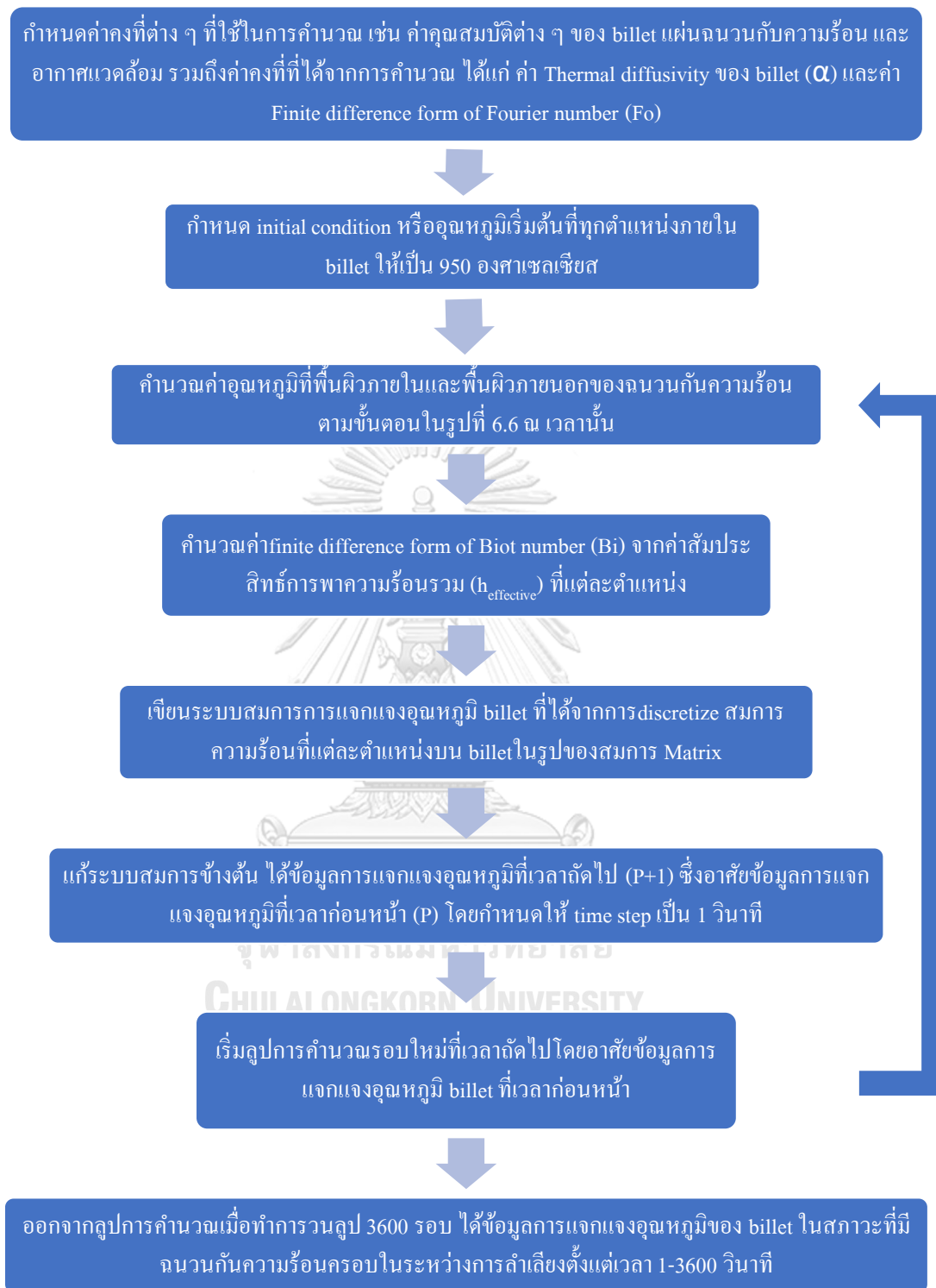
รูปที่ 6.7 แผนภาพขั้นตอนการทำงานของโปรแกรมคอมพิวเตอร์ที่ใช้ในการหาคำตอบของระบบ สมการของการแจกแจงอุณหภูมิที่แต่ละตำแหน่งภายใน billet
