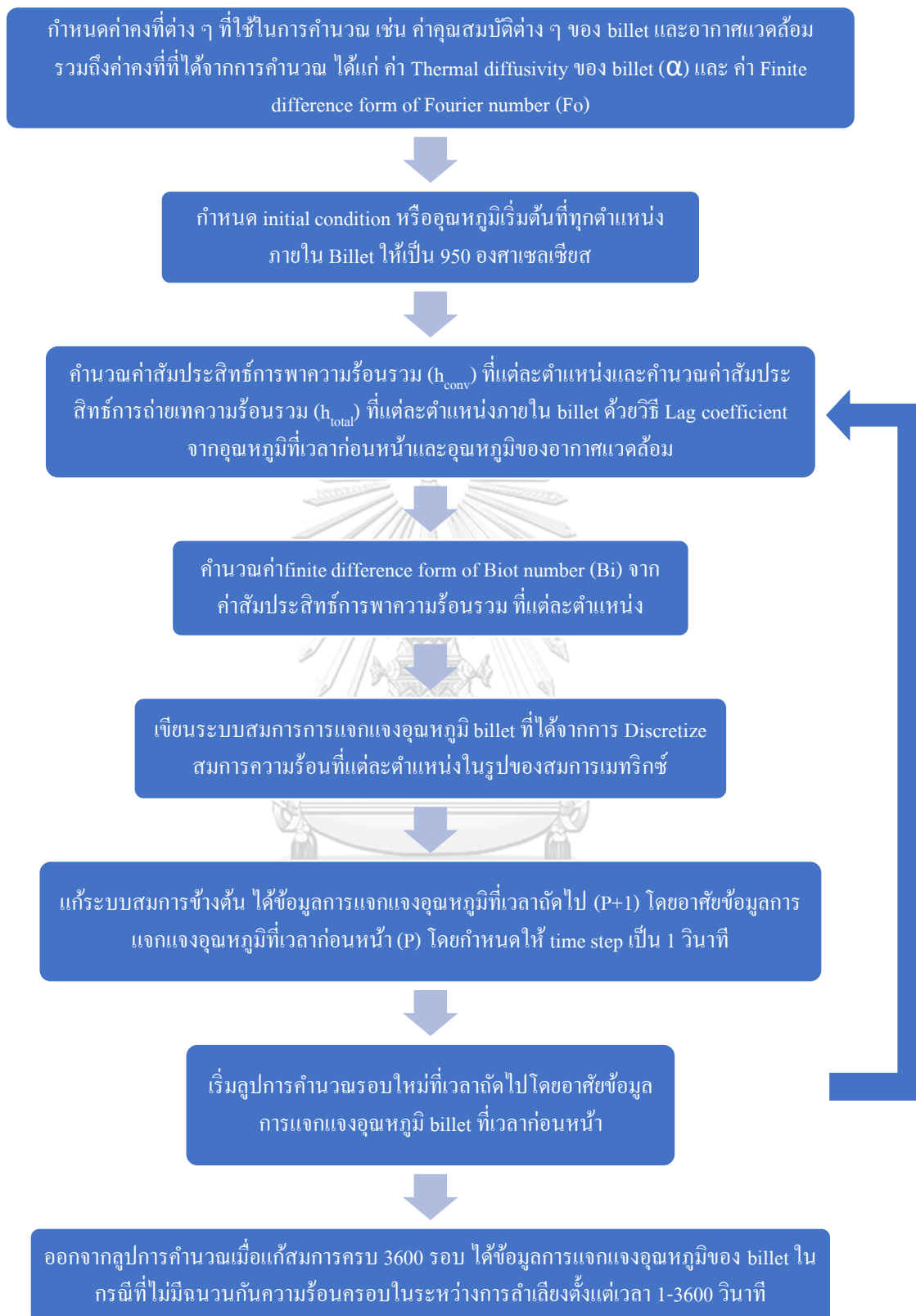
รูปที่ 6.1 แผนภาพขั้นตอนการทำงานของโปรแกรมคอมพิวเตอร์ที่ใช้ในการหาคำตอบของระบบสมการของการแจกแจงอุณหภูมิที่แต่ละตำแหน่งภายใน billet
