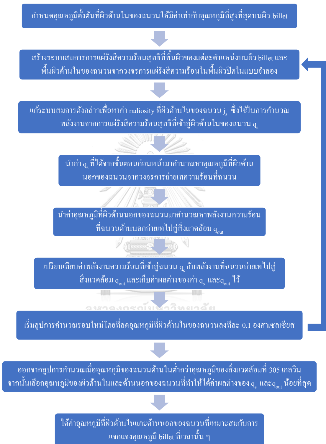
รูปที่ 6.6 แผนภาพขั้นตอนการทำงานของโปรแกรมคอมพิวเตอร์ที่ใช้ในการคำนวณหาอุณหภูมิของพื้นผิวภายในและพื้นผิวภายนอกของฉนวนกันความร้อนที่สอดคล้องกับการแจกแจงอุณหภูมิ billet ที่เวลาต่าง ๆ
