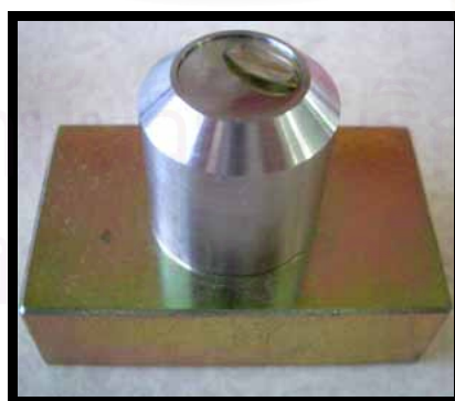
รูปที่ 15 แสดงแบบพิมพ์โลหะที่ใช้ในการเตรียมชี้นทดสอบ
