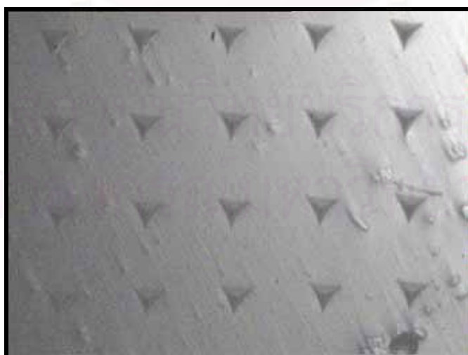
รูปที่ 20 แสดงรอยกดของวัสดุเคลือบหลุมร่องฟันยี่ห้อฟริโวแคร์ชนิดใสที่เสริมเส้นใย วัสดุของสารโคโตซานในปริมาณร้อยละ 1.2 โดยน้ำหนัก ที่กำลังขยาย 10 เท่า
