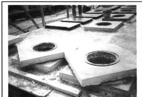
ภาพที่ 5-89 ฝ้าถ้งน้ำบาดหล่อสำเร็จรูป
