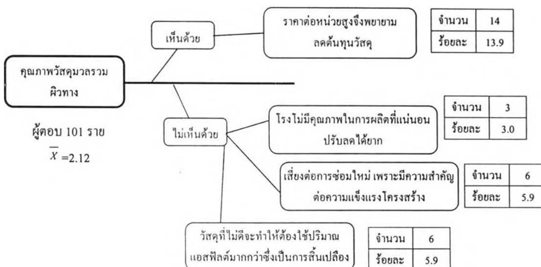
รูปที่ 5.6 Cause-Effect Diagram แสดงผลกระทบต่อ การลดคุณภาพวัสดุรวมผิวทาง
