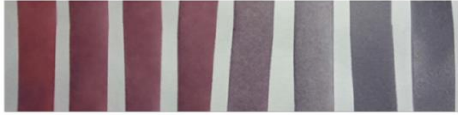
รูปที่ 1.12 การเปลี่ยนแปลงสีของกระดาษที่เคลือบด้วยอนุภาคทองคำนาโน (AuPNs) เมื่อมีปริมาณเมลามีนเพิ่มขึ้น 17
