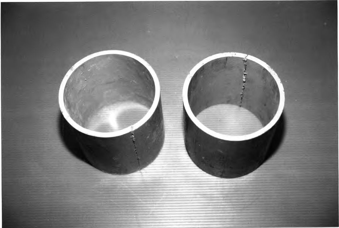
รูปที่ 12 แบบหล่อทรงกระบอกทำจากท่อพีวีซี
